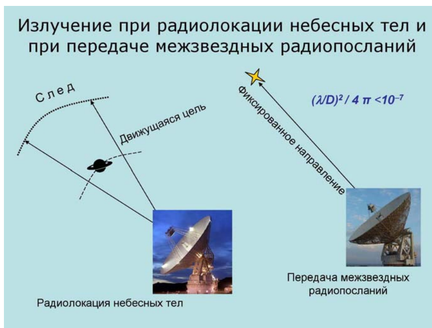
Рис. 2. Особенности излучения при радиолокации небесных тел и при передаче МРП.
